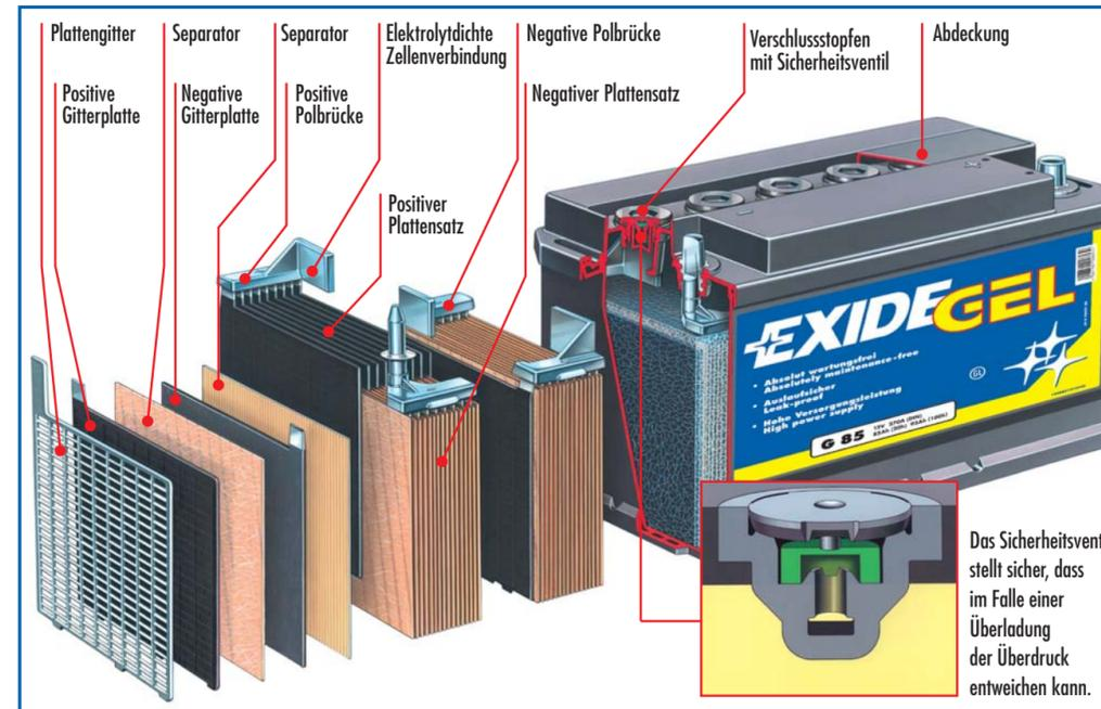
Das Sicherheitsventil stellt sicher, dass im Falle einer Überladung der Überdruck entweichen kann.
