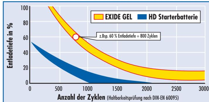
Beleg für mehr Leistung und Wirtschaftlichkeit: Im Vergleich zur HD-NKW-Starterbatterie erlaubt die EXIDE GEL bei gleicher Entladetiefe eine viel höhere Anzahl von Zyklen.
